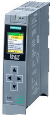
SIMATIC S7-1500T, CPU 1511TF-1 PN, Zentralbaugruppe mit Arbeitsspeicher 225 KB für Programm und 1 MB für Daten, 1. Schnittstelle: PROFINET IRT mit 2 Port Switch, 60 ns Bit-Performance, SIMATIC Memory Card notwendig
