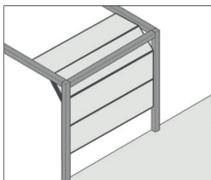
Die maximale Höhe für Sektionaltore beträgt 2175mm.
