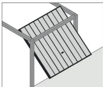
Die maximale Höhe für Schwingtore beträgt 2400mm.
