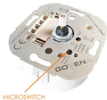
1 Die folgende Anleitung zeigt, wie Sie die Zusatzfunktionen des PRO-200-LT-LED Dimmers aufrufen. Änderung des Betriebsmodus von L (Phasenanschnitt) zu T (Phasenabschnitt) ermöglicht Ihnen eine Änderung des Ausschneidens der Sinusversorgungsspannung von ansteigender Flanke zu abfallender Flanke, d.h. die Verbesserung der Zusammenarbeit einiger Lampentypen mit dem PRO-200-LT-LED Dimmer. Werkseitig arbeitet der Dimmer im L Modus.
