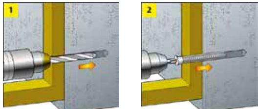
1. Loch durch den Rahmen in den Untergrund bohren
