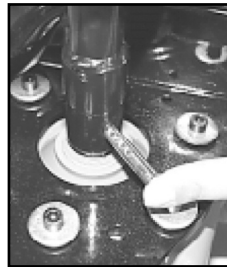
Abbildung 4 Erdbohrer aufgesetzt, Bolzen einsetzen
