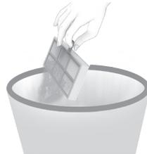
**!** **Wichtig:** Die Filterklappe lässt sich erst schließen, wenn Sie einen Filter einsetzen. Setzen Sie den Filter so ein, dass die Lasche nach oben zeigt. Erneuern Sie den Filter alle zwei Monate.
