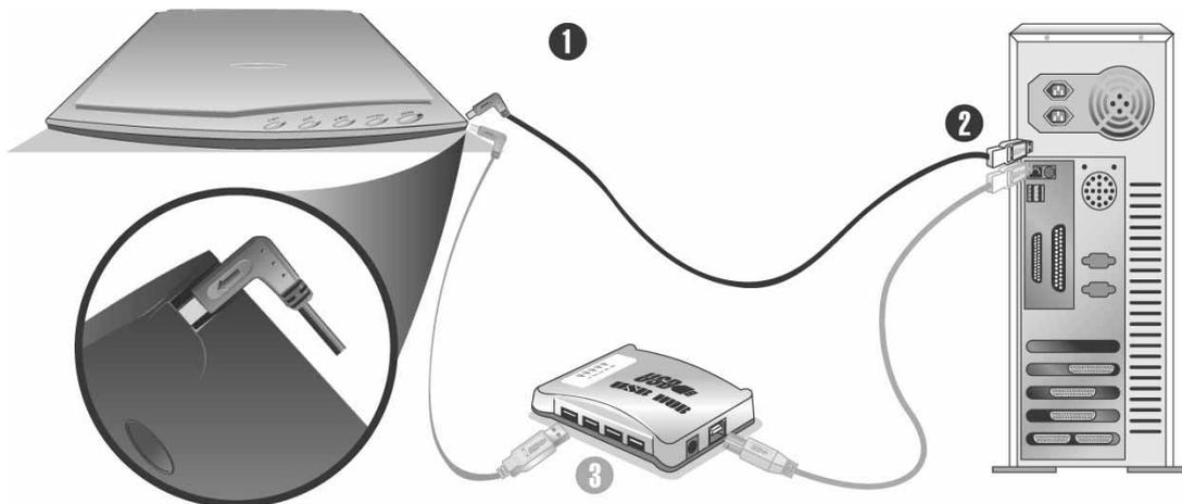
1. Schließen Sie den quadratisch geformten Stecker des mitgelieferten USB-Kabels an den USB-Anschluss des Scanners.
