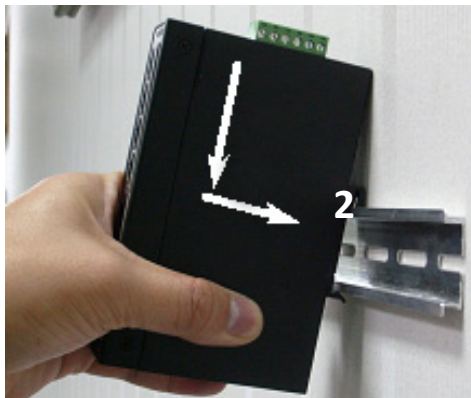
Abbildung 5: Gerät in die Hutschiene einsetzen.
