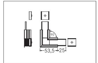
Verbindungsstück 90°, weiß lackiert. Material: Aluminium, Abmessung Profil: L: 53,5 mm x B: 53,5 mm x H: mm .
