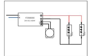
LED-Netzgerät 24 V DC, 1-10 V dimmbar (analog). Dieses Betriebsgerät erfüllt die Anforderungen für Sicherheitsbeleuchtungsanlagen nach DIN EN 50172 VDE 0108-100:2005-01. Dieser Konverter ist durch Sicherungseinrichtungen gegen Überspannung und Kurzschluss sowie thermische und elektrische Überlastung geschützt. Fassung: ohne, Material: Kunststoff, Schutzart: nach DIN EN 60529: IP20, Schutzklasse: (EN 61140) II, Spannung: 24V, Leistung: 1-20W, Art der Dimmung: 1-10 V.
