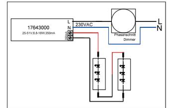
LED-Konverter 350 mA, Phasenabschnitt dimmbar. Dieser Konverter ist durch Sicherungseinrichtungen gegen Überspannung und Kurzschluss sowie thermische und elektrische Überlastung geschützt. Die Eingangs- und die Ausgangsklemme ist für Leitungen mit einem Querschnitt von bis zu 1,5 mm<sup>2</sup> geeignet.
