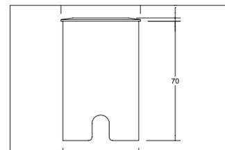
LED-Bodeneinbauleuchte V4A, IP65, edelstahl, rund. Einbaumontage, Bodenmontage. Montageart: Einbaumontage, Montageort: Bodenmontage, Material: Edelstahl / Aluminium / Glas, Schutzart: nach DIN EN 60529: IP65, Schutzklasse: (EN 61140) III, Spannung: 24V, Leistung: 1,4W, Anzahl der Leuchtmittel / Fassungen: 1.0 Stk, Lichtstrom: 3lm, Farbtemperatur: 3000K, Lichtfarbe: weiß, Abstrahlwinkel: 100°, ohne Betriebsgerät, .
