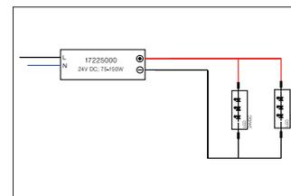
LED-Netzgerät 24 V DC, schaltbar. Dieser Konverter ist durch Sicherungseinrichtungen gegen Überspannung und Kurzschluss sowie thermische und elektrische Überlastung geschützt. Material: Aluminium, Schutzart: nach DIN EN 60529: IP65, Schutzklasse: (EN 61140) I, Spannung: 24V, Leistung: 75-150W, Art der Dimmung: schaltbar.
