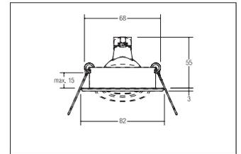
Einbaustrahler, schwarz / alu, rund. Ausgeführt in kompakter Bauform für werkzeuglose Schnellmontage zum Deckeneinbau. Fassung: GX5,3, Montageart: Einbaumontage, Montageort: Deckenmontage, Material: Aluminium, Schutzart: nach DIN EN 60529: IP20, Schutzklasse: (EN 61140) III, Spannung: 12V, Leistung: max. 50W, Anzahl der Leuchtmittel / Fassungen: 1.0 Stk, Verstellbarkeit: schwenkbar, ohne Betriebsgerät, Art der Dimmung: sonstige.
