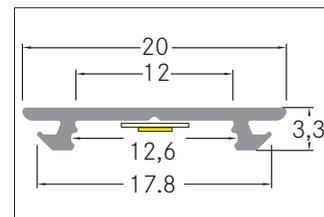
Flexibles Profil P72-12, alu eloxiert. Zur optimalen Befestigung des Profiles eignen sich die Halter 53020000 53021000 53022260 optimal geeignet. In Verbindung mit den Profilabdeckungen 53431070 kann sowohl ein zusätzlicher mechanischer Schutz als auch eine optimale Lichtverteilung erreicht werden. Das zugehörige Endkappen-Set steht unter 53078 zur Verfügung. Montageart: Spezialprofil, Material: Aluminium, Abmessung Profil: L: 2000 mm x B: 20 mm x H: 3,3 mm .
