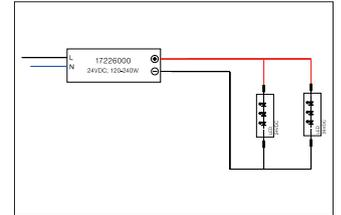
LED-Netzgerät 24V DC, schaltbar. Dieser Konverter ist durch Sicherungseinrichtungen gegen Überspannung und Kurzschluss sowie thermische und elektrische Überlastung geschützt. Material: Aluminium, Schutzart: nach DIN EN 60529: IP65, Schutzklasse: (EN 61140) I, Spannung: 24V, Leistung: 120-240W, Art der Dimmung: schaltbar.
