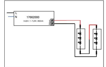
LED-Konverter 350 mA, schaltbar. Dieser Konverter ist durch Sicherungseinrichtungen gegen Überspannung und Kurzschluss sowie thermische und elektrische Überlastung geschützt. Die Eingangs- und die Ausgangsklemme ist für Leitungen mit einem Querschnitt von bis zu 1,5 mm<sup>2</sup> geeignet. Material: Kunststoff, Schutzart: nach DIN EN 60529: IP20, Schutzklasse: (EN 61140) II, Strom: 350 mA, Spannung: 230V AC 50Hz, Leistung: 1-7,2W, Dimmbar: Nein, Art der Dimmung: schaltbar.
