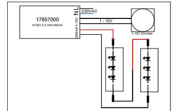
LED-Konverter 350 mA, 1-10 V dimmbar (analog). Dieser Konverter ist durch Sicherungseinrichtungen gegen Überspannung und Kurzschluss sowie thermische und elektrische Überlastung geschützt. Die Eingangs- und die Ausgangsklemme ist für Leitungen mit einem Querschnitt von bis zu 1,5 mm<sup>2</sup> geeignet. Material: Kunststoff, Schutzart: nach DIN EN 60529: IP20, Schutzklasse: (EN 61140) II, Strom: 350 mA, Spannung: 230V AC 50Hz , Leistung: 5,25-18W, Art der Dimmung: 1-10 V.
