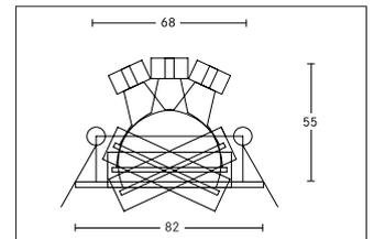
Deckeneinbauleuchte, weiß. Ausgeführt in kompakter Bauform für werkzeuglose Schnellmontage zum Deckeneinbau. Fassung: GX5,3, Montageart: Einbaumontage, Montageort: Deckenmontage, Schutzart: nach DIN EN 60529: IP20, Schutzklasse: (EN 61140) III, Spannung: 12V, Leistung: max. 50W, ohne Betriebsgerät, Art der Dimmung: sonstige.
