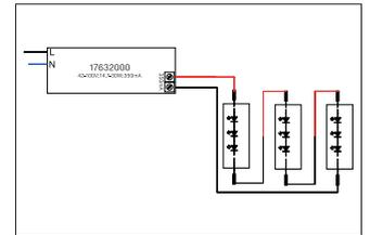
LED-Konverter 350mA, schaltbar. . Fassung: Plug&Play, Material: Kunststoff, Schutzart: nach DIN EN 60529: IP20, Schutzklasse: (EN 61140) II, Strom: 350 mA, Spannung: 230V AC 50Hz, Leistung: 14,7-30W, Art der Dimmung: schaltbar.
