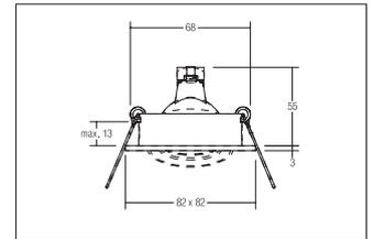
Einbaustrahler, schwarz / alu, quadratisch. Ausgeführt in kompakter Bauform für werkzeuglose Schnellmontage zum Deckeneinbau. Fassung: GX5,3, Montageart: Einbaumontage, Montageort: Deckenmontage, Material: Aluminium, Schutzart: nach DIN EN 60529: IP20, Schutzklasse: (EN 61140) III, Spannung: 12V, Leistung: max. 50W, Anzahl der Leuchtmittel / Fassungen: 1.0 Stk, Verstellbarkeit: schwenkbar, ohne Betriebsgerät, Art der Dimmung: sonstige.
