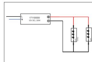
LED-Netzgerät 12 V DC, schaltbar. Dieser Konverter ist durch Sicherungseinrichtungen gegen Überspannung und Kurzschluss sowie thermische und elektrische Überlastung geschützt. Fassung: ohne, Material: Kunststoff, Schutzart: nach DIN EN 60529: IP20, Schutzklasse: (EN 61140) II, Spannung: 12V, Leistung: 1-30W, Art der Dimmung: schaltbar.
