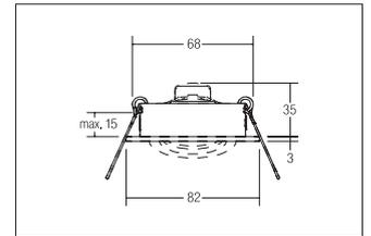
Deckeneinbau-Lautsprecher, DA 68 mm, titan. Ausgeführt in kompakter Bauform für werkzeuglose Schnellmontage zum Deckeneinbau. Nenn- / Musikbelastbarkeit: 3 / 4 W, Impedanz: 20 Ohm, Es können bis zu 5 Lautsprecher an einen Kanal eines Hifi-Verstärkers parallel angeschlossen werden.
