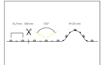
QualityFlex Performance Flexplatine CRI > 95, 5 W / m, IP00, LED-Weißlicht, 3000K, CRI > 95 LED-Flexplatine zur Dekorative-, Technische- sowie effiziente Beleuchtung von Lichtvouten, Linearanwendungen und Hinterleuchtungen, Grund- bzw. Allgemeinbeleuchtung von Räumen, architektonische Anwendungen und für Bereiche, in denen eine hohe Ausleuchtung gewünscht ist, wie z.B. indirekte oder direkte Beleuchtungen, Lichtdecken, Gastronomiebeleuchtungen und vielem mehr. Länge: 20000.0 mm
