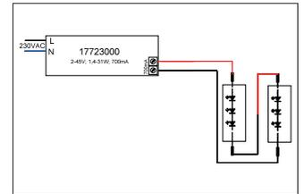
LED-Konverter 700 mA, schaltbar. Dieser Konverter ist durch Sicherungseinrichtungen gegen Überspannung und Kurzschluss sowie thermische und elektrische Überlastung geschützt. Die Eingangs- und die Ausgangsklemme ist für Leitungen mit einem Querschnitt von bis zu 1,5 mm<sup>2</sup> geeignet. . Material: Kunststoff, Schutzart: nach DIN EN 60529: IP20, Schutzklasse: (EN 61140) II, Strom: 700 mA, Spannung: 230V AC 50Hz , Leistung: 1,4-31W, Art der Dimmung: schaltbar.
