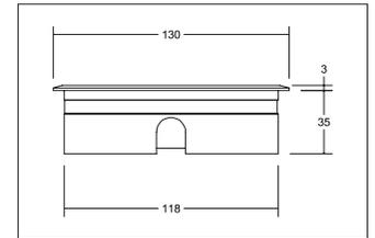
LED-Bodeneinbauleuchte HYBRIDE flat, V4A, IP67, edelstahl, rund. Einbaumontage, Bodenmontage. Montageart: Einbaumontage, Montageort: Bodenmontage, Material: Edelstahl / Aluminium / Glas, Schutzart: nach DIN EN 60529: IP67, Schutzklasse: (EN 61140) III, Spannung: 24V, Leistung: 9W, Anzahl der Leuchtmittel / Fassungen: 1.0 Stk, Lichtstrom: 450lm, Farbtemperatur: 3000K, Abstrahlwinkel: 30°, ohne Betriebsgerät, .
