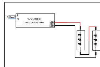
LED-Konverter 700 mA, schaltbar. Dieser Konverter ist durch Sicherungseinrichtungen gegen Überspannung und Kurzschluss sowie thermische und elektrische Überlastung geschützt. Die Eingangs- und die Ausgangsklemme ist für Leitungen mit einem Querschnitt von bis zu 1,5 mm<sup>2</sup> geeignet. . Material: Kunststoff, Schutzart: nach DIN EN 60529: IP20, Schutzklasse: (EN 61140) II, Strom: 700 mA, Spannung: 230V AC 50Hz , Leistung: 1,4-31W, Art der Dimmung: schaltbar.
