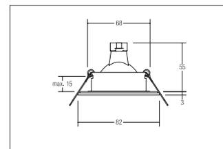
Einbaudownlight, V4A, IP54, edelstahl, rund. Ausgeführt in kompakter Bauform für werkzeuglose Schnellmontage zum Deckeneinbau. Fassung: GX5,3, Montageart: Einbaumontage, Montageort: Deckenmontage, Material: Edelstahl / Glas, Schutzart: nach DIN EN 60529: IP54\*, Schutzklasse: (EN 61140) III, Spannung: 12V, Leistung: max. 35W, Anzahl der Leuchtmittel / Fassungen: 1.0 Stk, Verstellbarkeit: nicht verstellbar, ohne Betriebsgerät, Art der Dimmung: sonstige.
