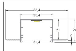
Einputzprofil P38-30, weiß lackiert. In Verbindung mit den Profilabdeckungen 53404000 53404070 kann sowohl ein zusätzlicher mechanischer Schutz als auch eine optimale Lichtverteilung erreicht werden. Das zugehörige Endkappen-Set steht unter 53092070 zur Verfügung. Montageart: Einbauprofil, Material: Aluminium, Abmessung Profil: L: 2000 mm x B: 63,4 mm x H: 24 mm .
