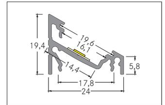
Komplett-Set Anbau-Eckprofil 1000mm, weiß. Material: Aluminium, Abmessung Profil: L: 1000 mm x B: 24 mm x H: 19,4 mm .
