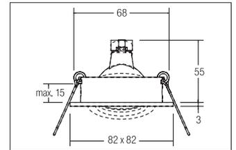
Einbaustrahler, weiß, quadratisch. Ausgeführt in kompakter Bauform für werkzeuglose Schnellmontage zum Deckeneinbau.
