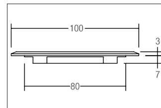
LED-Bodeneinbauleuchte, IP44, edelstahl, rund. Einbaumontage, Bodenmontage. Sehr flache Bodeneinbauleuchte für den Innenbereich.
