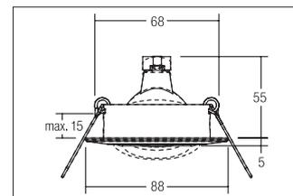
Einbaustrahler, chrom, rund. Ausgeführt in kompakter Bauform für werkzeuglose Schnellmontage zum Deckeneinbau. Fassung: GX5,3, Montageart: Einbaumontage, Montageort: Deckenmontage, Material: Guss, Schutzart: nach DIN EN 60529: IP20, Schutzklasse: (EN 61140) III, Spannung: 12V, Leistung: max. 50W, Anzahl der Leuchtmittel / Fassungen: 1.0 Stk, Verstellbarkeit: schwenkbar, ohne Betriebsgerät, Art der Dimmung: sonstige.
