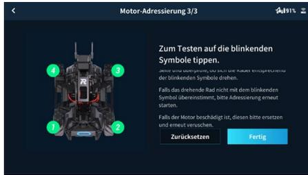
☞ Die Adressierung des Motors ist erforderlich, wenn ein Motor ausgetauscht wird. Öffnen Sie die RoboMaster-App, klicken Sie auf „Einstellungen“ dann auf „System“ und wählen Sie „Motoradressierung“ aus.
