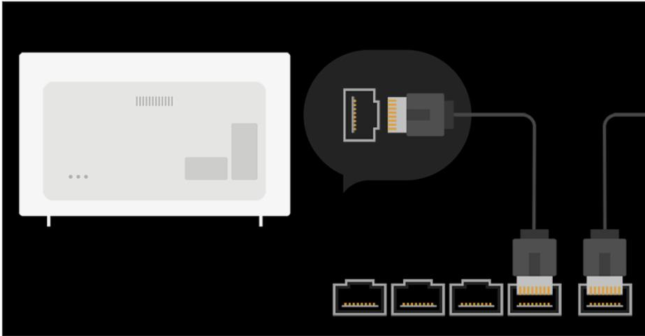
01 Schließen Sie den LAN-Anschluss des TV-Geräts über ein LAN-Kabel an den Router an.
