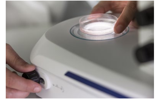
Die Durchlichtbasis mit Spiegel bietet Hellfeld-, einseitige Dunkelfeld- und Schräglichtbeleuchtung plus wahlweise Polarisationskontrast. Durch Drehen können Sie zwischen der satinieren und der regulären Spiegelseite wählen, und damit zwischen diffuser und kontrastreicher Hellfeldbeleuchtung.
