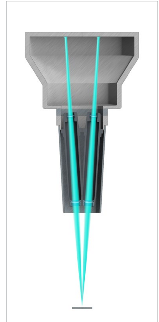
Prinzip Strahlengang eines Greenough-Stereomikroskops
