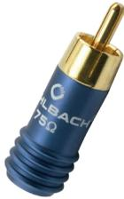
Dieser 75-Ohm-Cover-Connector ist speziell für nicht benutzte Digitalausgänge von CD-Spielern sowie hochwertigen DVD- und Blu-ray-Playern entwickelt worden. Als exakt definierter Abschluss-Widerstand für offene, nicht abschaltbare Cinch-Digitalausgänge, wirkt er dort auftretenden Reflexionen entgegen und verhindert wirkungsvoll eine klangverschlechternde Überlagerung des Hauptsignals. Die Tonübertragung von Digitalquellen wird hörbar natürlicher und deutlich präziser.
