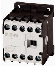
Leistungsschütz, 24 V DC, 3-polig, 380 V 400 V, 3 kW, Kontaktbestückung S
