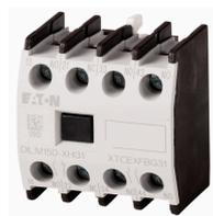
Hilfsschalterbaustein, 4 -polig, I<sub>th</sub>= 16 A, 2 S, 2 Ö, Frontbefestigung, Schraubklemmen, DILM40 - DILM170
