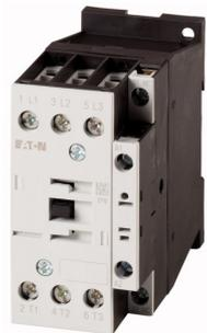
**Leistungsschütz, 3-polig, 380 V 400 V 11 kW, 1 Ö, RDC 24: 24 - 27 V DC, Gleichstrombetätigung, Schraubklemmen**
