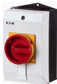
Hauptschalter, P1, 32 A, Aufbau, 3-polig + N, NOT-AUS-Funktion, mit rotem Drehgriff und gelbem Sperrkranz, abschließbar in 0-Stellung
