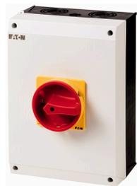
Hauptschalter, P3, 100 A, Aufbau, 3-polig, NOT-AUS-Funktion, mit rotem Drehgriff und gelbem Sperrkranz, abschließbar in 0-Stellung
