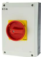
Hauptschalter, P3, 63 A, Aufbau, 3-polig, 1 Schließer, 1 Öffner, NOT-AUS-Funktion, mit rotem Drehgriff und gelbem Sperrkranz, abschließbar in 0-Stellung
