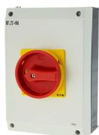
Hauptschalter, P3, 63 A, Aufbau, 3-polig + N, NOT-AUS-Funktion, mit rotem Drehgriff und gelbem Sperrkranz, abschließbar in 0-Stellung
