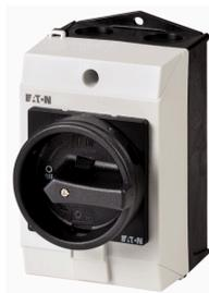
**Hauptschalter, T0, 20 A, Aufbau, 4 Baueinheit(en), 6-polig, 1 Schließer, 1 Öffner, HALT-Funktion, mit schwarzem Drehgriff und Sperrkranz, abschließbar in 0-Stellung**
