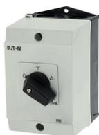
**Stern-Dreieck-Schalter, T3, 32 A, Aufbau, 4 Baueinheit(en), Kontakte: 8, 60 °, rastend, mit 0-Stellung, 0-Y-D, Abwicklungs Nr. 8410**
