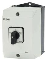
Umschalter, T3, 32 A, Aufbau, 4 Baueinheit(en), Kontakte: 8, 60 °, rastend, mit 0-Stellung, Netz-0-Notstrom, Abwicklungs Nr. 8902
