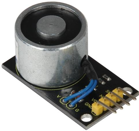
Dieser Elektromagnet eignet sich für kleinere Projekte (z. B. in den Bereichen Automatisierung, Mikrocontroller oder Robotik.) Bei 5 V erzeugt er eine Kraft von ca. 25 N (ca. 2,5 kg).
