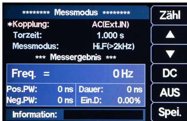
Drücken Sie **MEAS** um ins Messmodusmenü zu gelangen und drücken Sie die Menütaste **Zähl** bzw. **Mes.**, um zwischen der Zähl- und der Messfunktion umzuschalten. Durch drücken von **SHIFT + MEAS** gelangen Sie direkt zur Zählfunktion.
