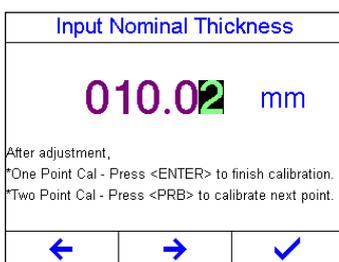
Abbildung unten: Messen des zweiten Punkts während der Zweipunktkalibrierung.
