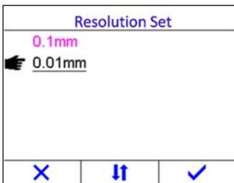
Wenn die Auflösung auf 0,01 mm eingestellt ist, sollte die Oberfläche des Prüfstücks glatt sein, um genaue Testergebnisse zu erhalten. Bei der Messung von rauen Oberflächen bzw. grobkörnigen Materialien wird es empfohlen, die niedrige Auflösung zu verwenden.
